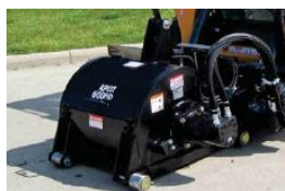
งานขุดไส้ผิวดถนน
