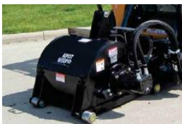
งานขุดไถผิวถนน
